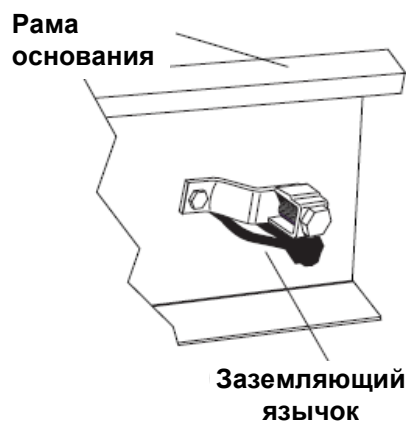
Рисунок 2.2. Заземляющий язычок генератора (типовой)
