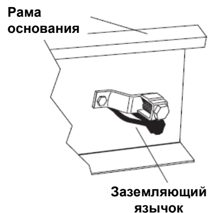
Рисунок 2.2. Заземляющий язычок генератора (типовой)
