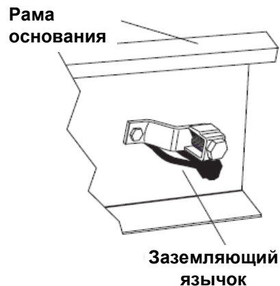
Рисунок 2.2. Заземляющий язычок генератора (типовой)
